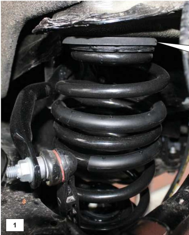
Die Gummiunterlage wird oben montiert.
